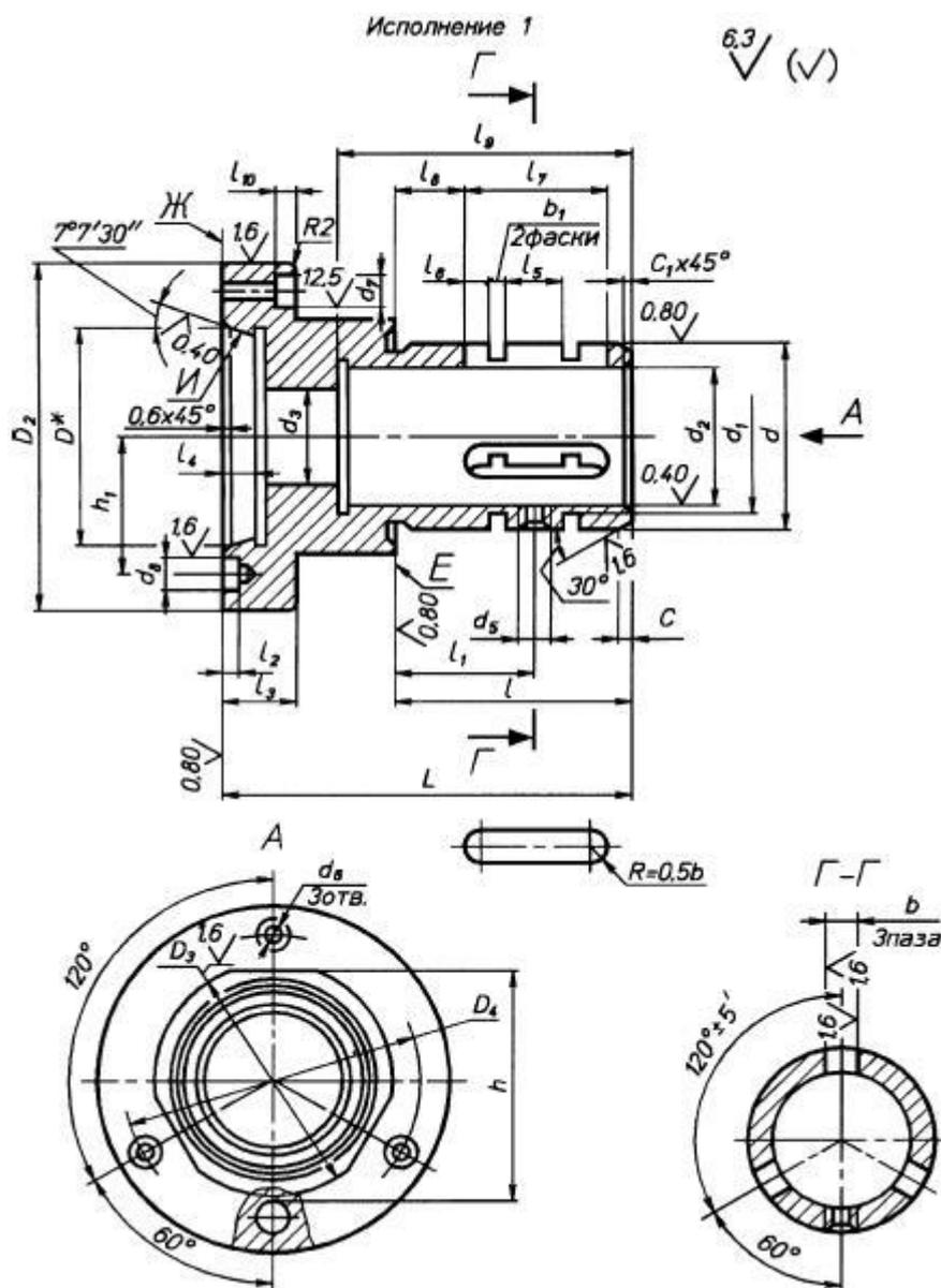
\* Диаметр  $D$  соответствует пересечению конической поверхности с торцевой. Рисунок А.19
