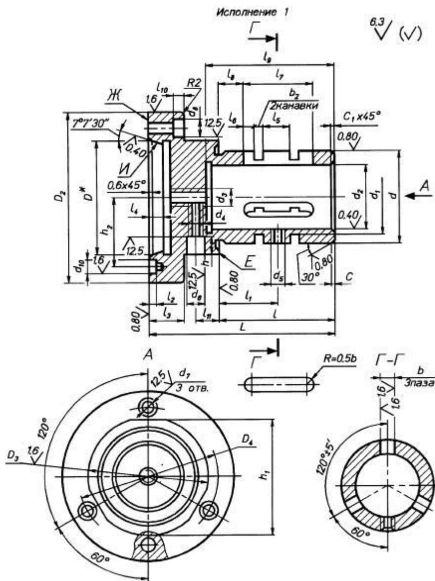
\* Диаметр  $D$  соответствует пересечению конической поверхности с торцевой. Рисунок А.13
