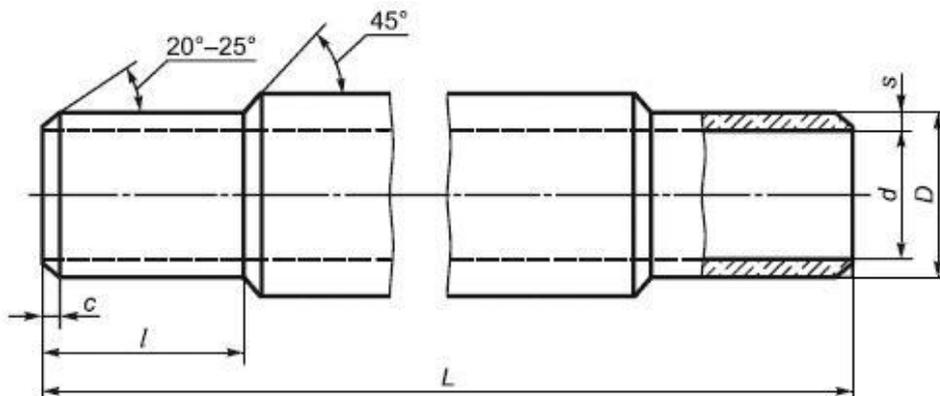
Рисунок 3 - Напорная труба
