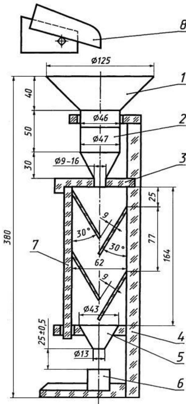
1 - большая приемная воронка; 2 - малая воронка; 3 - объемная крышка; 4 - корпус; 5 - направляющая воронка; 6 - стакан емкостью  $25 \text{ см}^3$ ; 7 - система четырех пластинок; 8 - лотковый вибропитатель Рисунок 1 - Волюмометр
