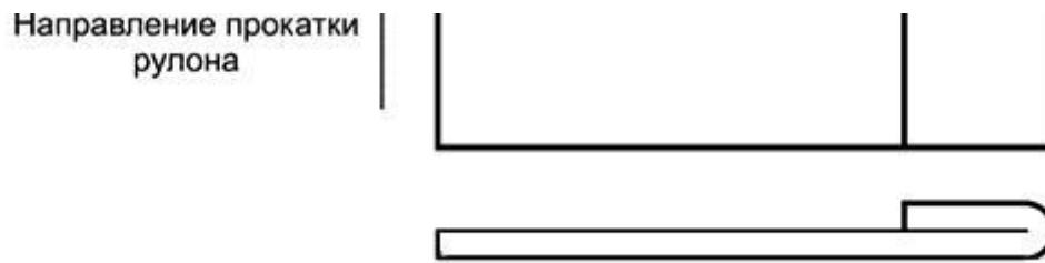
Рисунок Д.1 - Схема измерения прочности полимерного покрытия при изгибе
